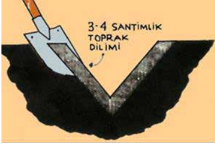
Resim 4. Toprak örneğinin alınması
